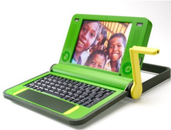
Figura 1.8: Imagen del XO con el dispositivo para recargar la batería sin necesidad de electricidad
