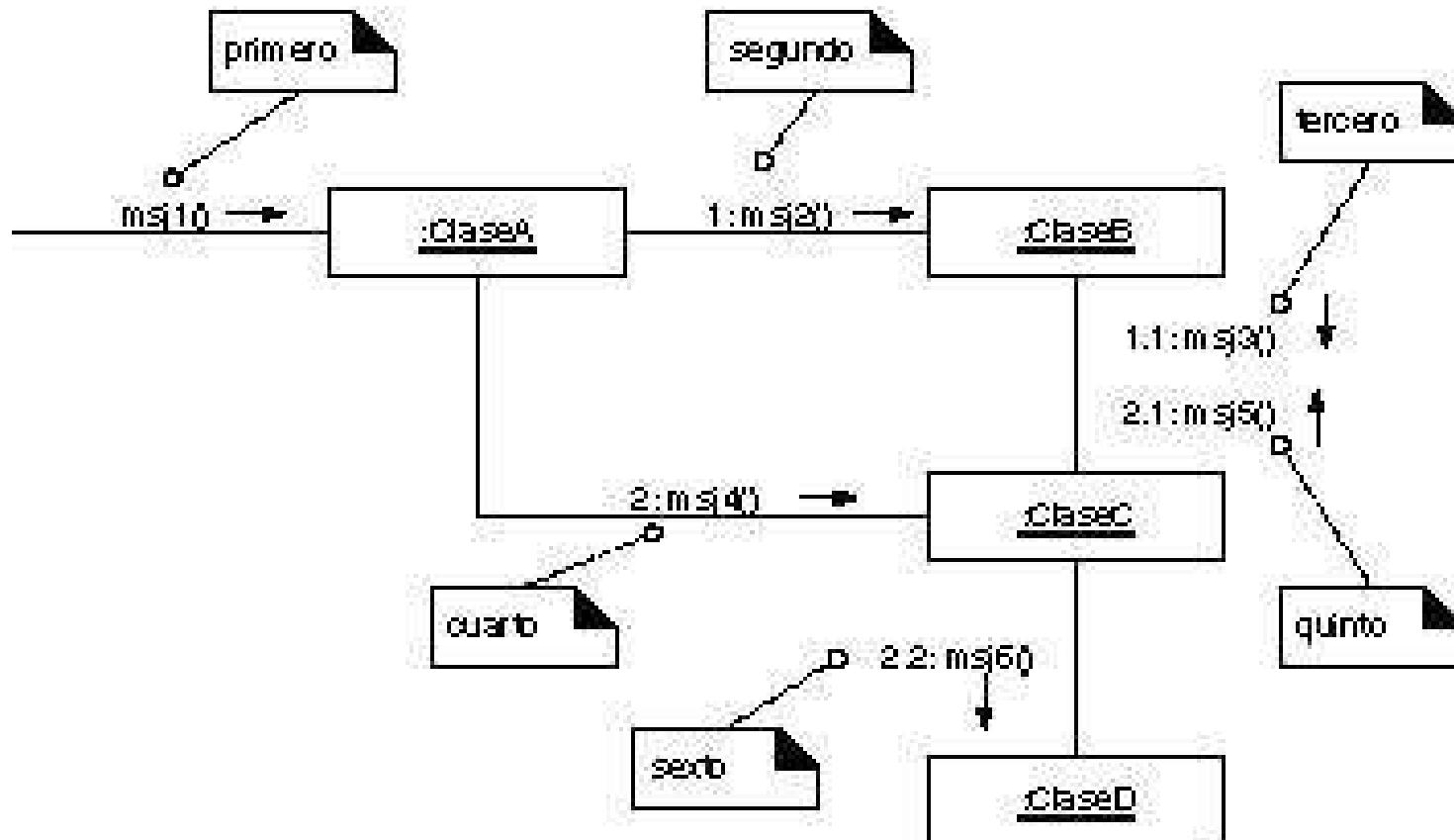
**Figura 15.12.** Mensaje condicional.
