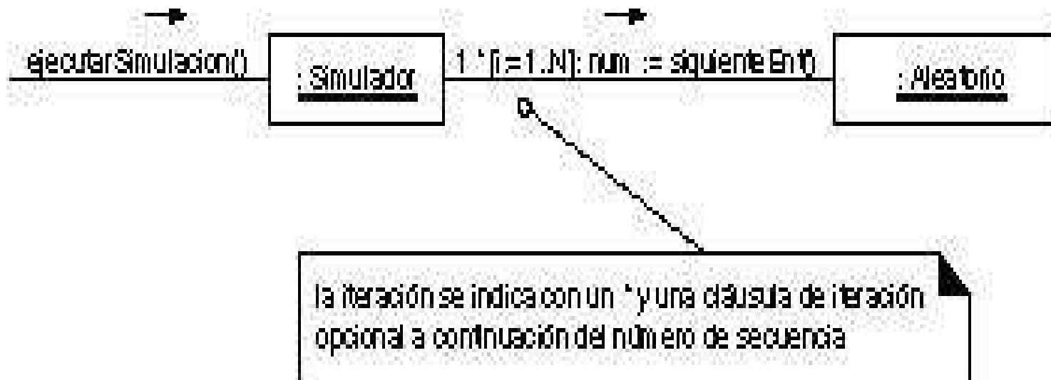
**Figura 15.15.** Iteración sobre un multiobjeto.
