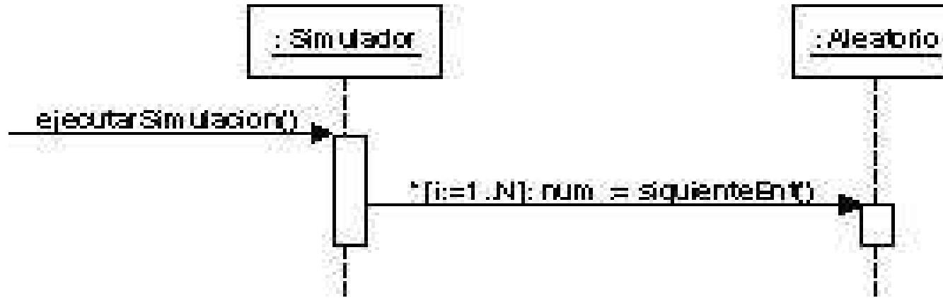
**Figura 15.25.** Iteración sobre una secuencia de mensajes.
