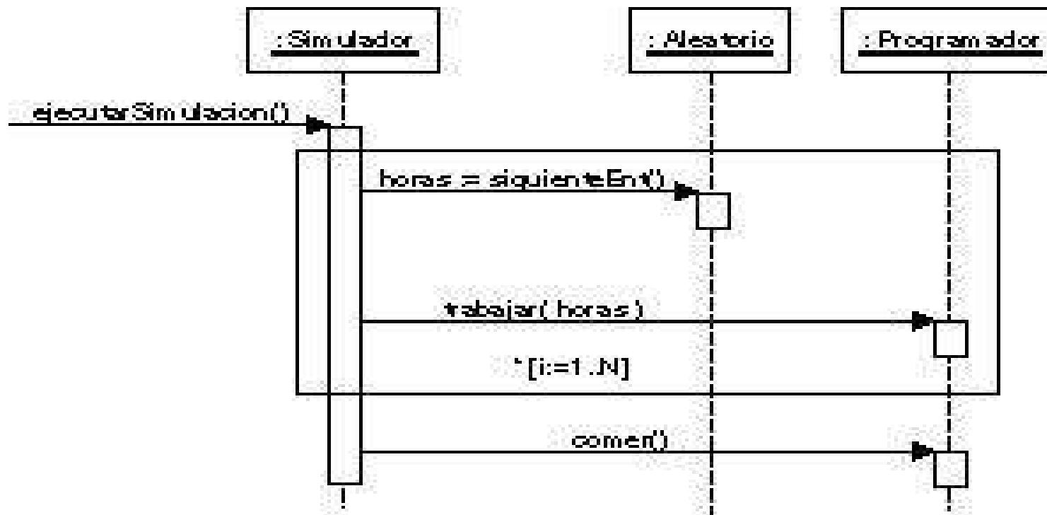
**Figura 15.26.** Iteración sobre un multiobjeto.
