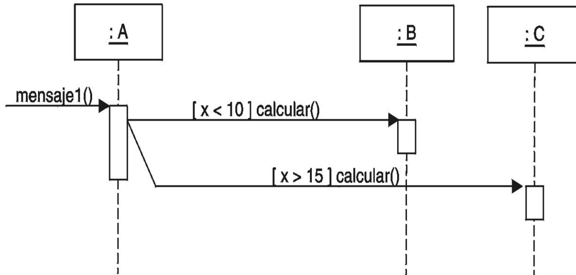
**Figura 15.24.** Iteración para un mensaje.
